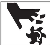
Les fraises sont tranchantes. Porter des gants pour installer la fraise sur l'arbre ou l'en retirer. Ne pas saisir une fraise en rotation.
