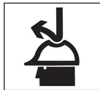
La débouchure est éjectée à la fin du perçage. Ne pas orienter la fraise ou l'arbre de telle manière que la débouchure risque de frapper quelqu'un aux alentours ou en dessous lorsqu'elle est éjectée.
