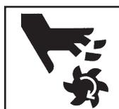
**ATTENTION!** Les fraises sont tranchantes. Porter des gants pour installer la fraise sur l'arbre ou l'en retirer. Ne pas saisir une fraise en rotation.
