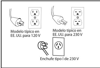
Si las conexiones eléctricas están mojadas, habrá riesgo de descarga. A fin de evitar que el lubricante para corte recorra el cable y entre en contacto con el enchufe o tomacorriente, realice un lazo de goteo, como se ilustra a continuación. Además, eleve los cables de extensión o las conexiones de las cajas de distribución eléctrica.
