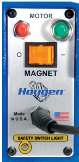
PLACA DE INTERRUPTORES DEL PANEL DE CONTROL
